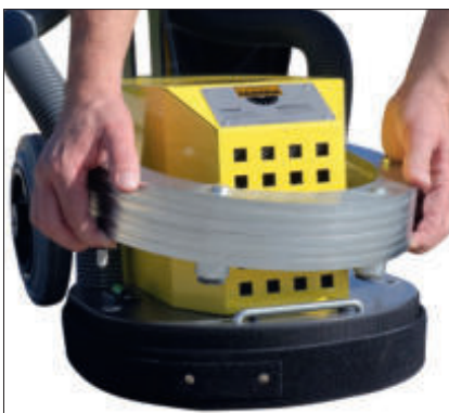
Aufsteckbares Zusatzgewicht 10 kg.
