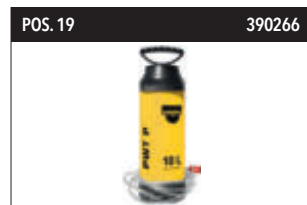
POS. 19 390266 KBZ 720 PWT P Wasserdruckbehälter 10 l Ausführung mit Kunststoff-Tank. Zum Durchführen netzunabhängiger Nassbohrungen. Wasseranschluss passend für SAMEDIA-Kernbohrmaschinen und Schnellkupplung, Schlauchanschluss 1/2".
