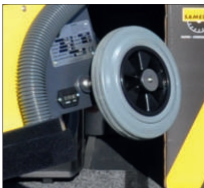
Betriebsstundenzähler an der Seite.
