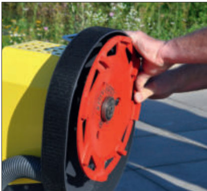
Flexibel gelagerte Antriebswelle.
