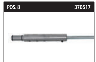
POS. 8 370517 KBZ 410 Zentrierstange zum Freihandbohren für Bohrkronen-Länge 350–450 mm (für Bohrmotor BMF 200 geeignet), Steckverbindung
