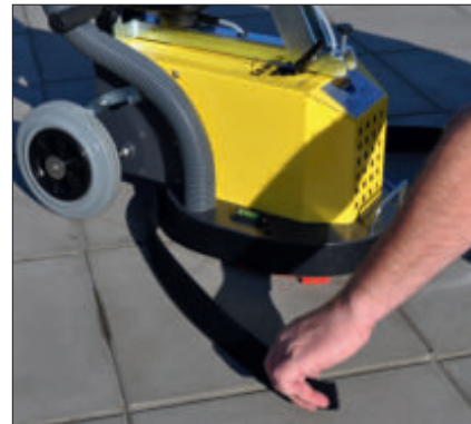
Anpassbares, flexibles Klettstaubbund.
