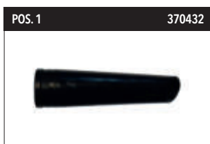
Adapter Muffe konisch Gummi; außen Ø 50/37 mm; 200 mm Länge Ideal für Anschluss CGR 125- 220 bzw. CGR 180-220.
