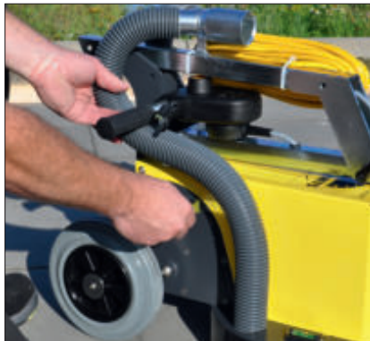
Eenvoudige machineconfiguratie via hellingsmechanisme + libel.
