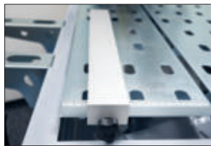
Langsaanslag van massief aluminium passend bij de verzonken schaal.
