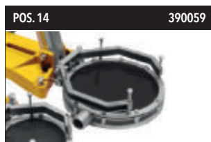
POS. 14 390059 KBZ 250 Wateropvangringen Ø250 Hoogwaardige aluminiumuit- voering. Ter voorkoming van waterschade tijdens stationair nat boren. Passend bij boorstatief BSP220 (390058) en BSP300 (390204).
