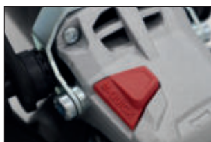
Quick-schakelaar voor de vergrendeling van de spil.
