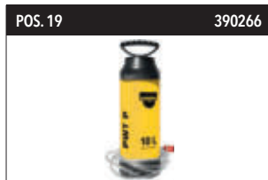
POS. 19 390266 KBZ 720 PWT P Waterdrukreservoir 10 l Uitvoering met kunststof tank voor het uitvoeren van net- onafhankelijke natte boringen. Wateraansluiting passend voor alle SAMEDIA-kernboormachi- nes en snelkoppeling (Garde- na), slangaansluiting 1/2".
