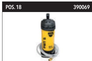
POS. 18 390069 KBZ 700 PWT S Waterdrukreservoir 10 l Hoogwaardige uitvoering met roestvrijstalen tank en drukven- tel. Voor het uitvoeren van net-onafhankelijke natte boringen. Wateraansluiting passend voor alle SAMEDIA-kernboormachi- nes en snelkoppeling (Garde- na), slangaansluiting 1/2".
