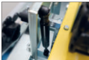
Geïntegreerde gasdrukdemper voor maximale snij nauwkeurigheid en functionaliteit.
