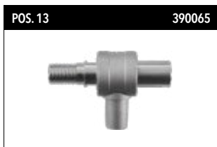
POS. 13 390065 KBZ 500 Extractor de polvo para perforaciones en seco El diseño preciso totalmente metálico para una extracción eficaz del polvo durante la perforación en seco. Aumenta la velocidad de corte y la vida útil de la broca, evita «atascos». Apto para coronas de 1 1/4". Se puede utilizar con todas las aspiradoras industriales disponibles en el mercado.
