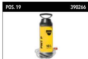
POS. 19 390266 KBZ 720 PWT P Depósito agua a presión 10 l Diseño con tanque de plástico. Para realizar perforaciones en húmedo independientes de la red. Conexión de agua apta para todas las perforadoras de núcleo SAMEDIA y enganche rápido, conexión de manguera 1/2".
