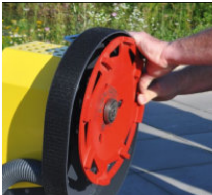
Eje de transmisión montado de forma flexible.
